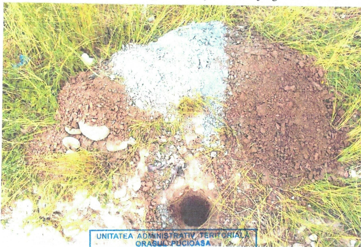
Foto 2 – Succesiunea litologică interceptată în forajul geotehnic nr. 1
